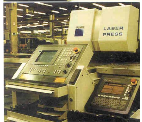
Bei der jüngst installierten 'Trumatic 600 Laserpress', die mit der neuen 'Sinumerik 840D' von Siemens ausgestattet ist, sind NC-Programme und Technologietabellen getrennt. Mithin kann der Bediener über die grafische Oberfläche der Steuerung noch optimierend eingreifen.
