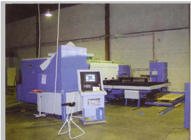
Stanzen, Umformen und Lasern in einer Aufspannung
