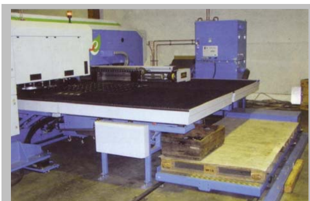
Komplexe Teile bis zu 8mm Blechdicke werden mit dem Laser geschnitten
