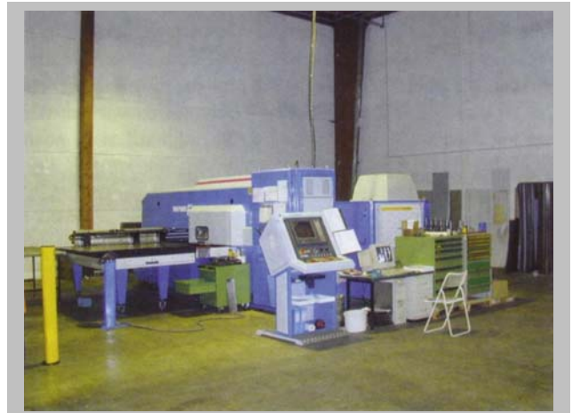
In der LPE 5 ist ein 2,5 kW CO2-Laser des Type TRIAGON von Rofin Sinar eingesetzt
